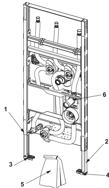
9310017 – TECEprofil Waschtischmodul inklusive zwei Montageblöcke zur Aufnahme von Wasserzähler-Messkapseln, Bauhöhe 1120 mm
