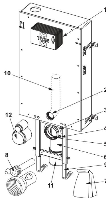
9370500 – TECEbox Octa II-Spülkasten 8 cm für Stand-WC, mit Armierungsgewebe, Bauhöhe 1075 mm
