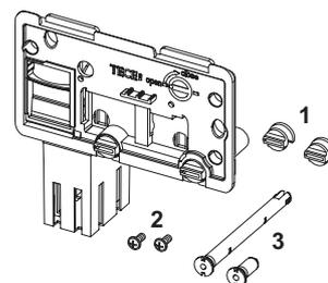
TECE-Einwurfschacht II für Reinigungstabs (TECElux Mini, TECESquare Glas, TECEvelvet, TECEloop und TECEnow)
