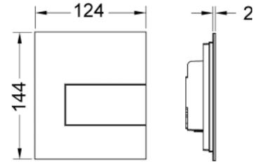
Einbau nur in Verbindung mit dem Urinal-Einbaurahmen (Best.-Nr. 9242647), bitte separat bestellen!
