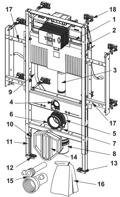
9300303 – TECEprofil WC-Modul mit Uni-Spülkasten, mit Anschluss für Geruchsabsaugung, Bauhöhe 1120 mm
