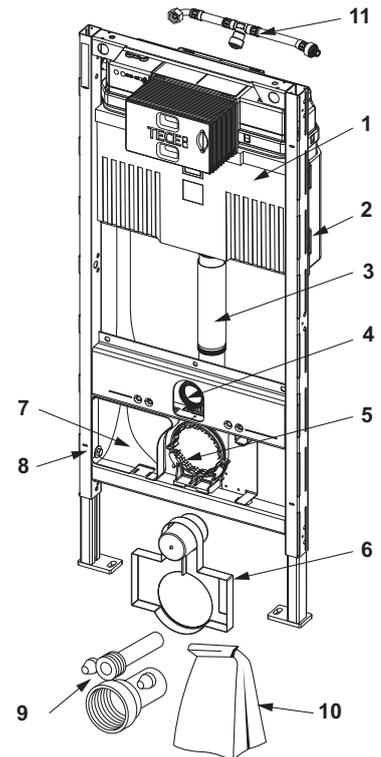
TECEprofil WC-Modul mit Uni-Spülkasten, für den universellen Anschluss eines Dusch-WCs, Bauhöhe 980 mm
