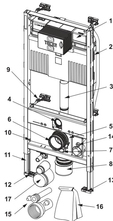
9300309 – TECEprofil WC-Gerontomodul mit Uni-Spülkasten, Keramikbefestigung für 48 cm Sitzhöhe gemäss DIN 18040-1, Bauhöhe 1120 mm
