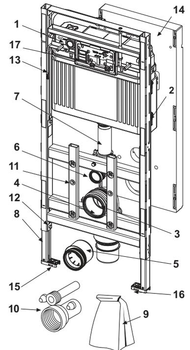
9600400 – TECElux WC-Modul 400, nachträglich höhenverstellbar, mit Geruchsabsaugung, Bauhöhe 1120 mm
