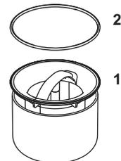
3601400 – TECEDrainpoint S Ablauf DN 50 superflach mit Seal System Universalflansch
