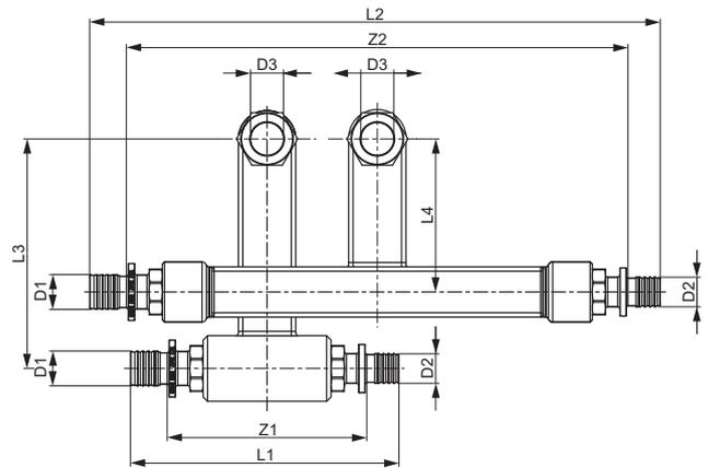
Raccord à compression TECEflex pour tube entièrement en plastique
