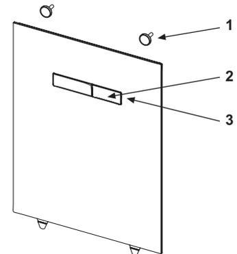
Plaque avant supérieure en verre avec déclenchement électronique sen-Touch
