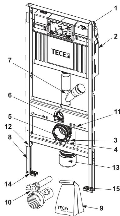
9300309 – Module WC Gérontomodule TECEprofil avec réservoir Uni, fixation de la cuvette pour une hauteur d'assise de 48 cm selon DIN 18040-1, hauteur 1120 mm
