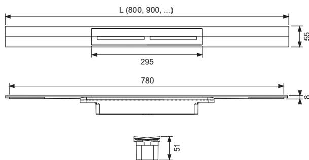
**Siphon « plat » TECEdrainprofile, sortie latérale DN 40\***
