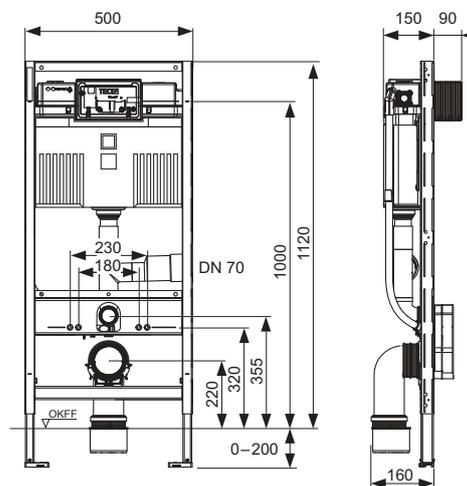
**Module WC TECEprofil avec réservoir Uni pour cuvette enfants sur pied, hauteur 1120 mm** NEW
