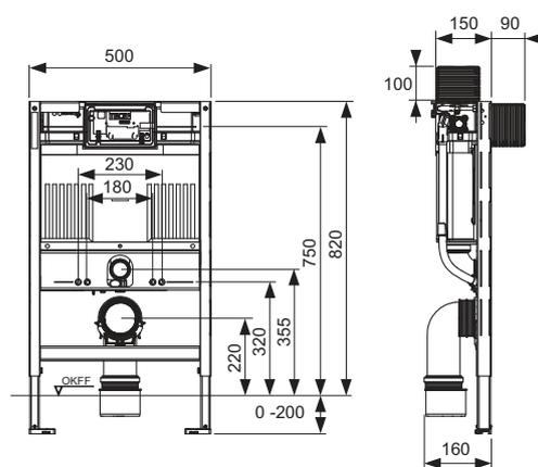
**Module WC TECEprofil avec réservoir Uni, pour TOTO Neorest Washlet (WC) AC 2.0 / EW 2.0, hauteur 1120 mm** **NEW**
