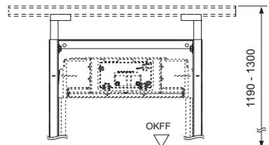
**Fixation de module TECEprofil, réglable en hauteur pour un montage personnalisé**
