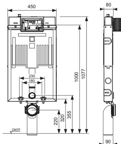
**Module de lavabo TECEbox, profondeur d'installation 8 cm**
