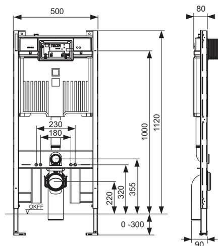
**Module WC TECEprofil avec réservoir Octa II 8 cm, avec raccordement **NEW** pour aspiration des odeurs, hauteur 1120 mm**
