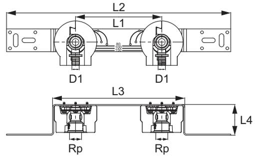
Platine pré-assemblée TECEflex pour montage mural, bronze, et éléments antibruit, laiton standard
