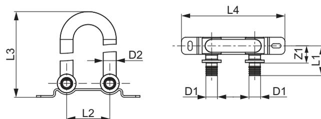
Kit de montage de radiateur TECEflex pour radiateur compact avec vanne intégrée, montage mural, nickelé
