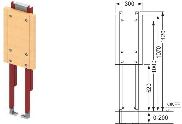
**Plaque de fixation TECEprofil pour poignées d'appui et systèmes de maintien**
