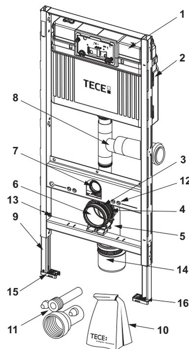
9300388 – Module WC TECEprofil avec réservoir Uni pour cuvette enfants sur pied, hauteur 1120 mm
