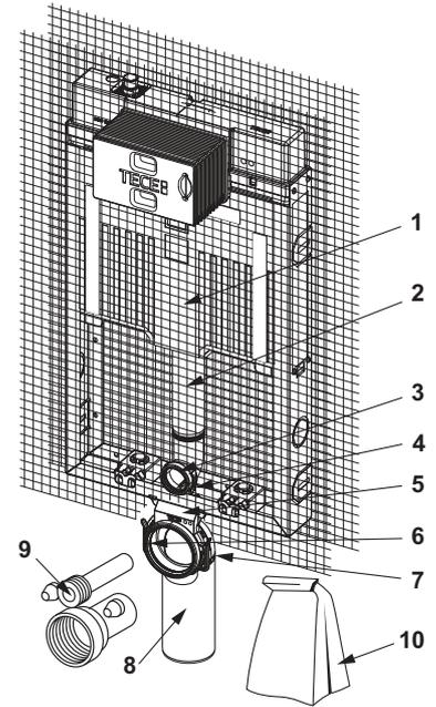
9370008 – Module WC TECEbox avec réservoir Octa, 8 cm, pour WC suspendu, hauteur 1110 mm
