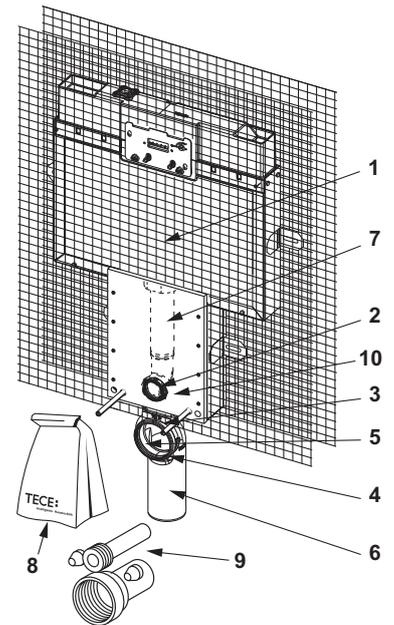
9370032 – Module de lavabo TECEbox, profondeur d'installation 8 cm
