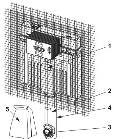
9370007 – Réservoir TECEbox Octa, 8 cm, pour toilettes surélevées, avec renfort, hauteur d'installation 1110 mm
