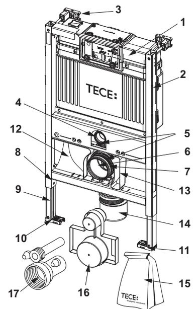
9300500 – Module WC TECEprofil avec réservoir Octa II, 8 cm, hauteur 1120 mm
