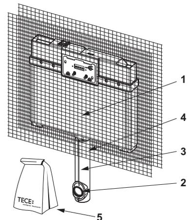
9370501 – Réservoir TECEbox Octa II, 8 cm, pour WC suspendu, hauteur 1075 mm
