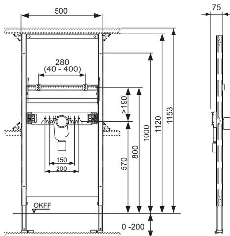
**Module de lavabo TECEprofil pour siphon anti-odeur encastré, hauteur 820-980 mm**
