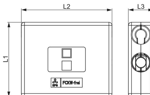
Boîtier d'installation TECEflex pour radiateur et vannes compacts
