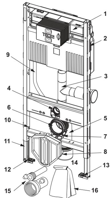
9300003 – Module WC TECEprofil avec réservoir Uni, avec raccordement pour aspiration des odeurs, hauteur 1120 mm
