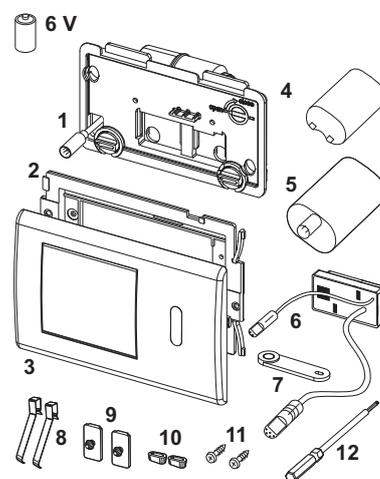
TECEplanus électronique antivandalisme avec capteur IR, réseau 12 V
