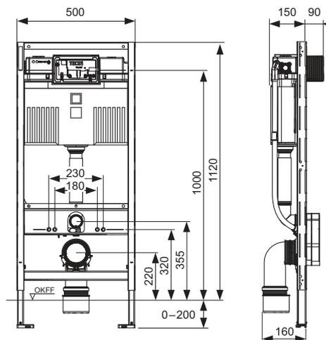
**Module WC TECEprofil avec réservoir Uni, avec fonction intégrée de chasse hygiénique pour réseau eau chaude et eau froide, hauteur 1120 mm** **NEW**
