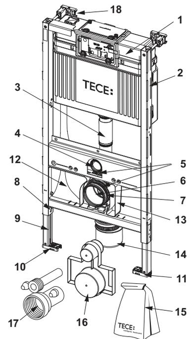
9300080 – Module WC TECEprofil avec réservoir Uni, pour le raccordement universel d'un WC-douche, hauteur 820 mm
