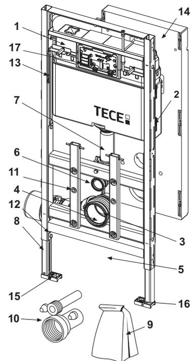
9600400 – Module TECElux 400, hauteur 1120 mm, réglable en hauteur après installation, avec aspiration des odeurs
