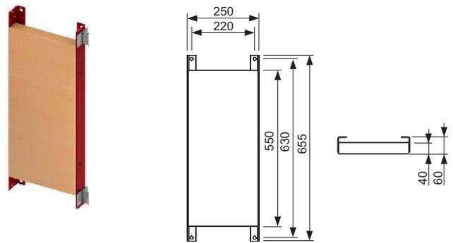
**Fixation de module TECEprofil avec réglage de profondeur et fermeture rapide**
