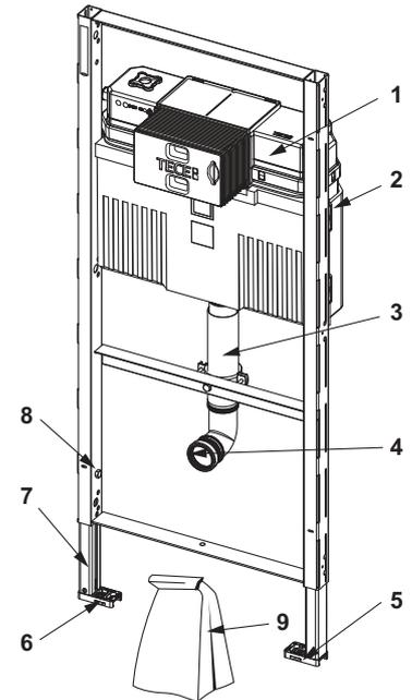
9300079 – Module WC TECEprofil avec réservoir Uni, pour le raccordement universel d'un WC-douche, hauteur 1120 mm
