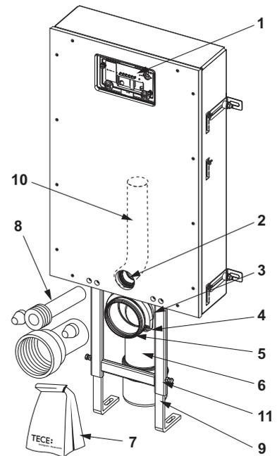
9370500 – Réservoir TECEbox Octa II, 8 cm, pour cuvette sur pied, avec tissu de renforcement, hauteur 1075 mm
