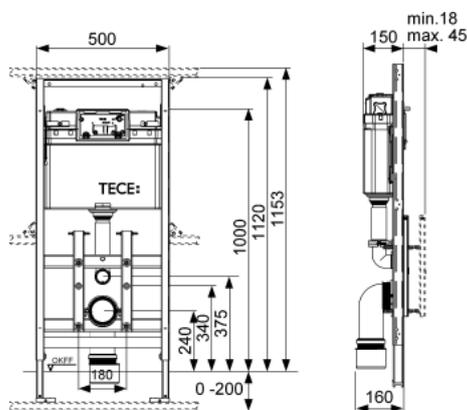
**Module TECElux 200, hauteur 1120 mm, réglable en hauteur après installation**
