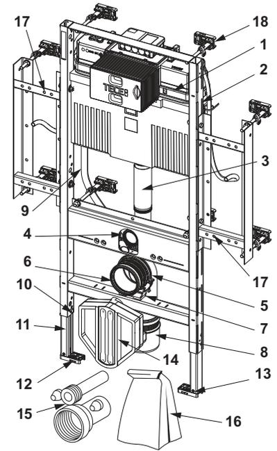
9300009 – Module WC Gérontomodule TECEprofil avec réservoir Uni selon DIN 18040-1, hauteur 1120 mm
