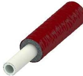
**Tube multicouche TECEflex en PE-Xc/Al/PE-RT, pré-isolé avec mousse PE 9 mm, rouge**
