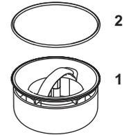
3601200 – Kit d'évacuation TECEdrainpoint S 120, normal avec flasque d'étanchéité universelle Seal System
