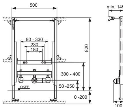
**Module TECEprofil pour poignées d'appui et systèmes de maintien**
