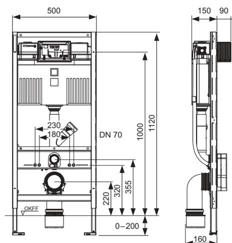
**Module WC Gérontomodule TECEprofil avec réservoir Uni, fixation de NEW la cuvette pour une hauteur d'assise de 48 cm selon DIN 18040-1, hauteur 1120 mm**
