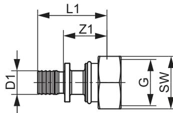
Raccord Eurocône 3/4" TECEflex avec raccord à sertir TECEflex en laiton standard
