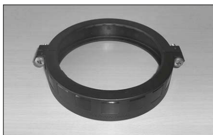
(BILD 13) Från dimension da 125 finns två skruvar anordnade mittemot varandra som båda måste dras åt tills de sitter fast. Det maximala åtdragningsmomentet är 7 nm.
