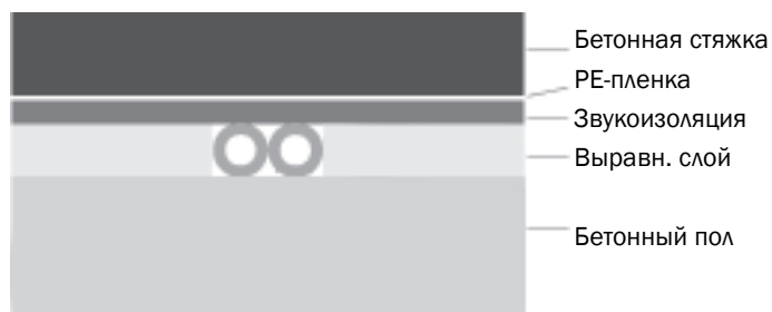
Пример прокладки трубопровода TECEflex в полу
