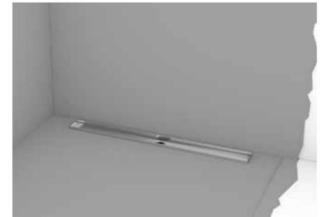
**Schritt 7:** Vollständiges Aufbringen der Verbundabdichtung
