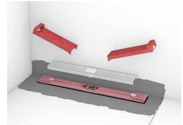
**Schritt 5:** Nach dem Verfüllen mit Estrich wird der Bauzeitenschutz entfernt, und die erste Schicht der Verbundabdichtung aufgetragen.
