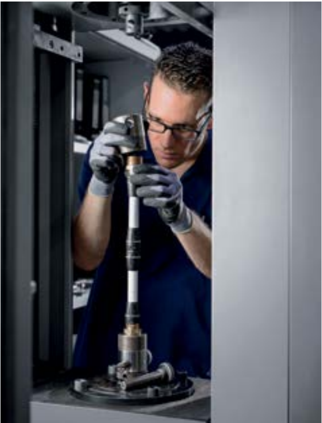
Rury i złączki przechodzą badania trwałości połączeń w celu zapewnienia maksymalnego bezpieczeństwa. Gwarantuje to długotrwałą stabilność instalacji.
