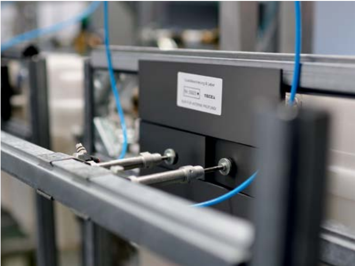
Mechanizm uruchamiający przycisk splotujący poddaje się badaniom zmęczeniowym podczas 200 000 cykli. Po takim teście urządzenie powinno pozostać w pełni sprawne.
