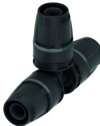
Les raccords à clipser prévus pour les diamètres de 16 mm, 20 mm, 25 mm, 32 mm, 40 mm, 50 mm et 63 mm et les accessoires existant pour cette gamme sont constitués d'un insert en PPSU noir (polyphénylsulfone).
