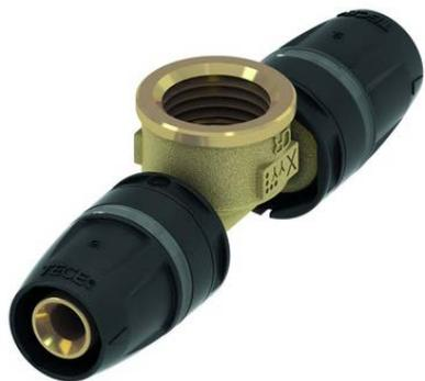
Les raccords à clipser prévus pour les diamètres de 16 mm, 20 mm, 25 mm, 32 mm, 40 mm et 50 mm et les accessoires existant pour cette gamme se composent d'un insert en laiton non étamé résistant au dézingage CuZn36Pb2As (CW602N) dont la fabrication et le post-traitement thermique sont conformes à la NBN EN 12164 et à la NBN EN 12168.
