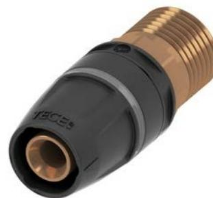
Les raccords à clipser prévus pour les diamètres de 16 mm, 20 mm, 25 mm, 32 mm, 40 mm, 50 mm et 63 mm et les accessoires existant pour cette gamme se composent d'un insert en bronze CuSn5Zn5Pb2-C (CC499K) dont la fabrication et le post-traitement thermique sont conformes à la NBN EN 12164 et à la NBN EN 12168.
